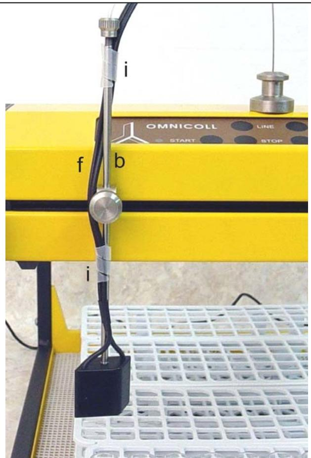
Schliessen Sie den Tropfenzähler (Detektor) mit dem Kabel an die „DROP“-Buchse des Kommunikationsmoduls an.
