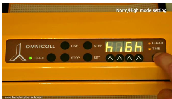
Obrázek 3.7-2 Pomocí tlačítka COUNT/TIME zvolte režim “high”.
