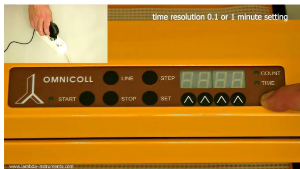
Obrázek 3.4-7 Stiskněte tlačítko „VÝBĚR“ a při stálém stisknutí současně zapněte napájení do sítě.
