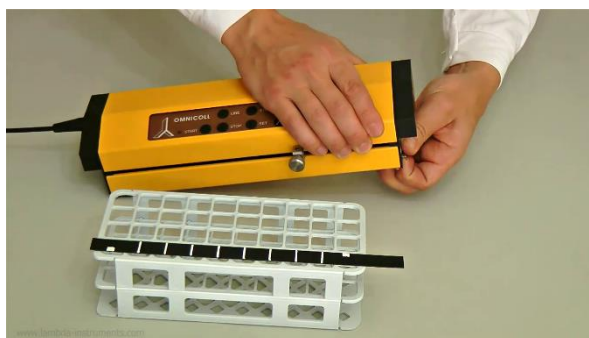
Obrázek 3.2-2 Vytáhněte držák kódovacího pásku z vozíku.
