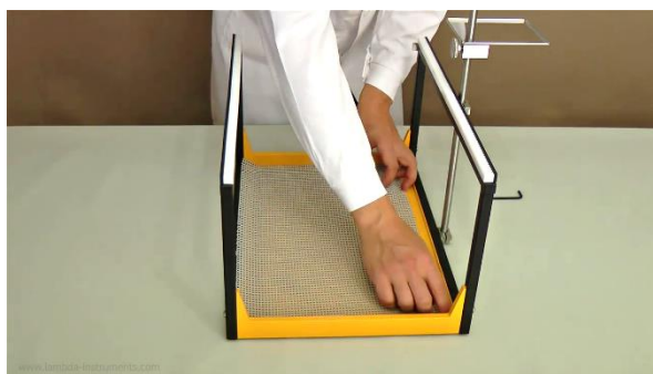
Obrázek 1.1-8 Vložte fixační podložku na dno podstavce. Tuto lepidlou podložku lze snadno regenerovat odstraněním prachu vlhkou hadrou nebo umytím ve vlažné vodě. Před použitím musí být podložka suchá.
