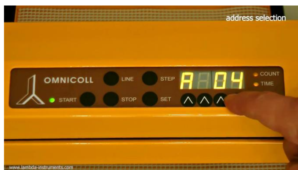
Obrázek 3.4-17 Pro změnu adresy stisknete tlačítka ▲▲▲▲ pod displejem, dokud není dosažena požadovaná hodnota.
