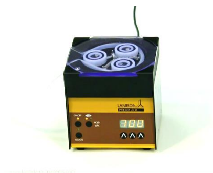
Obrázek 3.6-5 Na pumpě nastavte libovolnou hodnotu rychlosti, např. 700, zvolte směr otáčení a zapněte pumpu (pumpa je prozatím blokována kolektorem).
