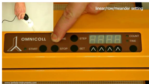
Obrázek 3.4-2 Stiskněte tlačítko „LINE“ a při stálém stisknutí současně zapněte napájení do sítě. Na displeji se objeví „Mod“ a následně posledně zvolený režim např. „row“.
