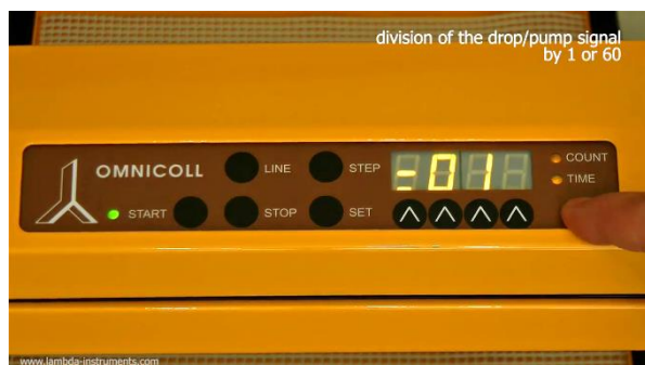
Obrázek 3.4-13 Stisknutím tlačítka COUNT/TIME zvolte požadovaný dělicí faktor.
