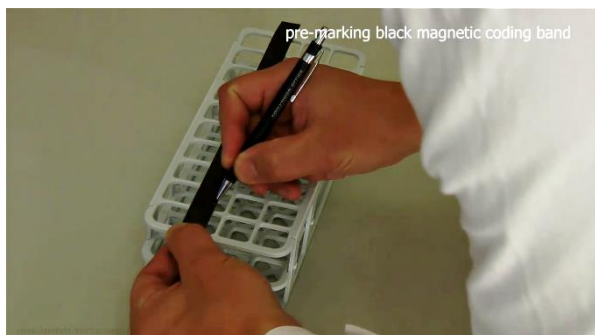
Obrázek 3.3-1 Umístěte kódovací magnetickou pásku na stojánek a tužkou si zaznačte vzdálenost mezi jednotlivými frakcemi.
