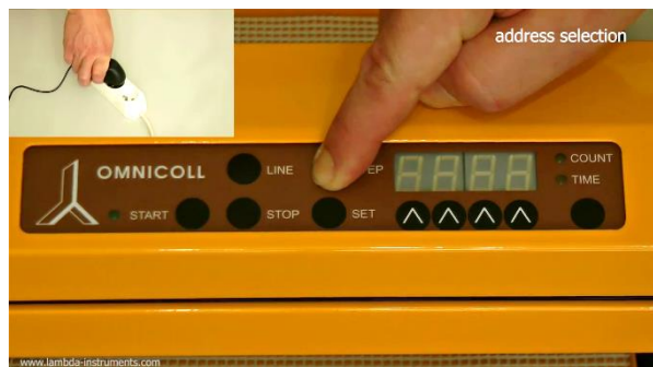
Obrázek 3.4-15 Stiskněte tlačítko STEP a při stálém stisknutí současně zapnete napájení do sítě.
