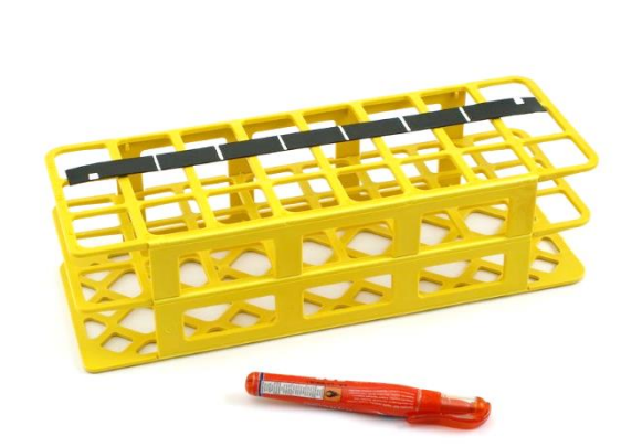
Obrázek 3.1-3 Začátek a konec řady je označen krátkou čarou (přibližně do poloviny magnetické pásky, čára je široká cca 5 mm). Začátek řady je indikován čarou vedoucí od spodního okraje pásky a konec řady čarou vedoucí od horního kraje pásky.
