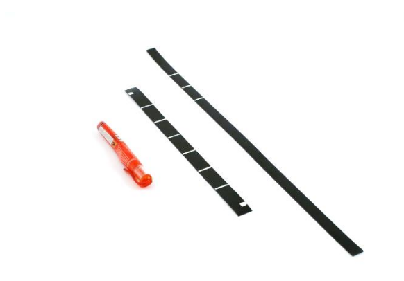
Obrázek 3.1-2 Jak lze vidět pozice frakcí jsou označeny bílými čarami na magnetické kódovací pásce.
