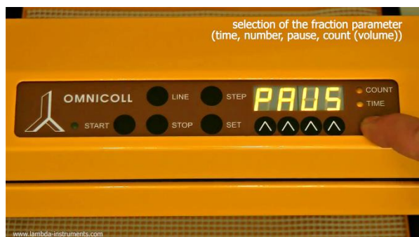
Obrázek 3.7-6 Volba parametru PAUSE (vlození pauzy). [Count LED: svítí; Time LED: svítí; Displej: PAUS]
