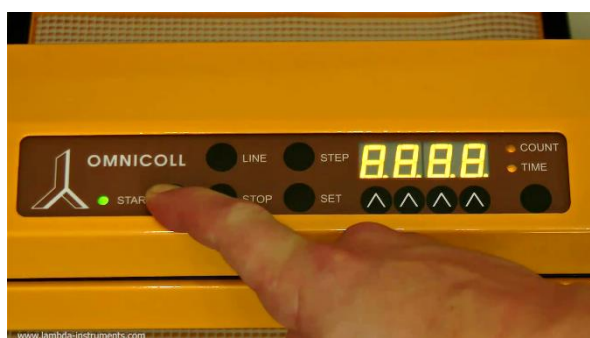
Obrázek 3.6-6 Stiskněte tlačítko START na kolektoru pro spuštění sběru frakce. Po změně frakce změřte její objem (u vody lze snadno zjistit objem vážením) a spočítejte počet impulsů pro Váš objem. Tento objem odpovídá nastavenému počtu zde například 55. Z poměru objem/počet lze pak snadno vypočítat počet odpovídající požadovanému objemu frakce.
