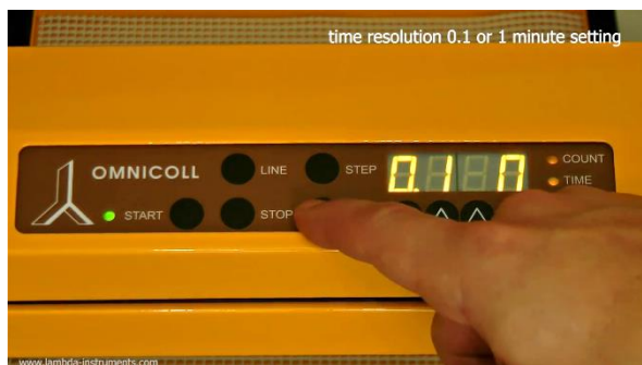
Obrázek 3.4-10 Volbu potvrďte stisknutím tlačítka „SET“.
