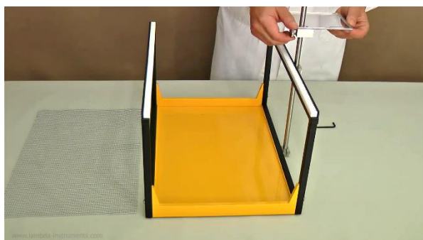
Obrázek 1.1-7 Nerezovou tyč vsuňte do fixačních matic na pravé straně rámu a zašroubujte imbusovým klíčem. V případě potřeby přišroubujte na tyč podstavec například pro pumpu.
