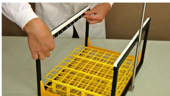
Obrázek 3.2-1 Naprogramovaná kódovací magnetická páska (osa Y a X) pro Vámi zvolený stojánek je dodána spolu s OMNICOLlem. Vložte tenčí a delší kódovací pásku na rám pod levou ozubenou tyč. Pásek drží magneticky a může být posunut podle potřeby.
