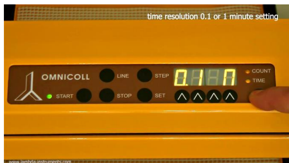
Obrázek 3.4-9 Stisknutím tlačítka VÝBĚR lze zvolit krok 0,1 minuta "0.1M" nebo krok 1 minuta "1M".
