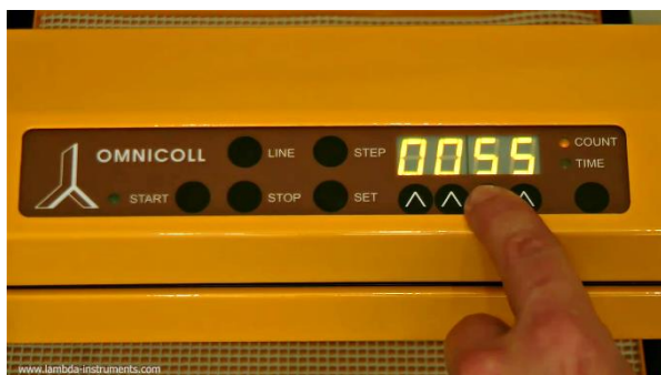
Obrázek 3.6-3 Vyberte požadovaný počet pomocí tlačítek ▲ ▲ ▲ ▲ pod displejem, například: 55.
