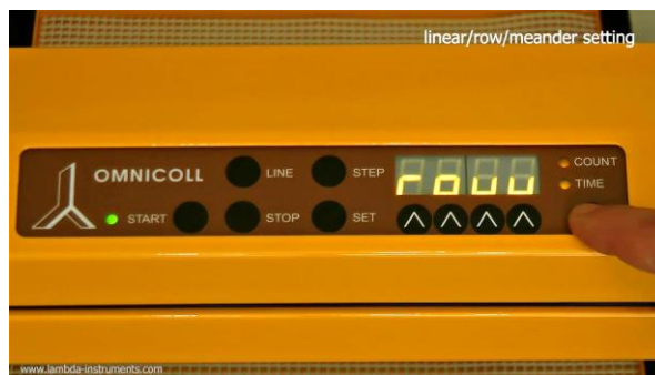
Obrázek 3.4-3. Stiskněte tlačítko VÝBĚR (pod COUNT / TIME) a zvolte požadovaný režim („Line“, „Mean“ nebo „row“).
