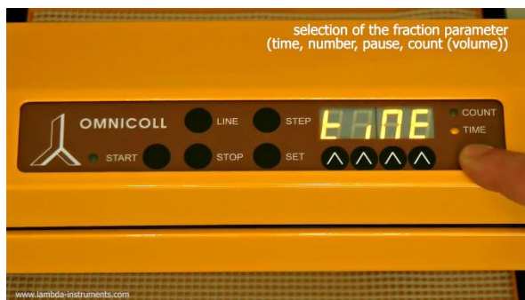
Obrázek 3.7-5 Volba parametru TIME (čas). [Count LED: nesvítí; Time LED: svítí; Displej: tiMe]
