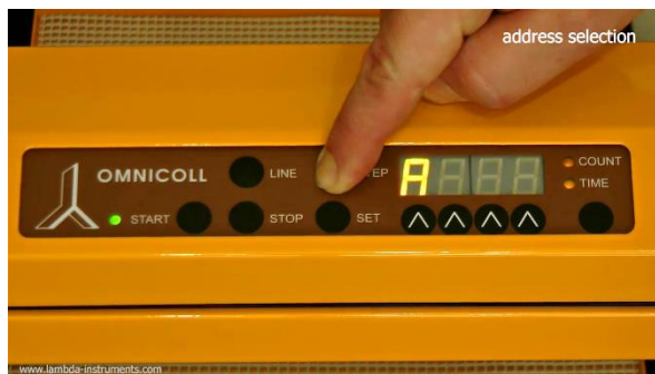
Obrázek 3.4-16 Na displeji se objeví zpráva "A" a dvě čísla. Toto číslo 00-99 je aktuální adresa sběrače frakcí.
