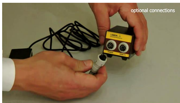
Obrázek 1.3-4 Zapojte napájecí zdroj do konektoru "POWER" komunikačního modulu.
