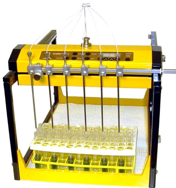
Obrázek 3.8-2 Ukázka 6kanálové konfigurace OMNICOLLu pro sběr frakcí v počtu 6x2.
