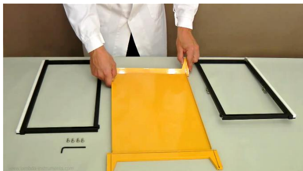
Obrázek 1.1-1 Zasuňte první kratší stranu podstavce do drážky podpěry
