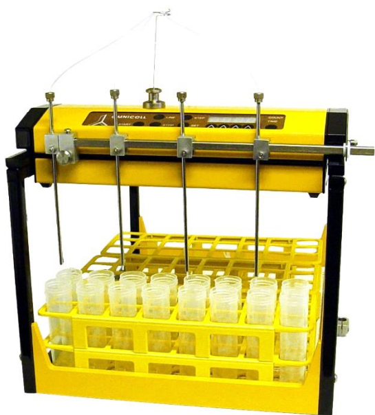
Obrázek 3.8-1 Ukázka 4kanálové konfigurace OMNICOLLu pro sběr frakcí v počtu 4x2.
